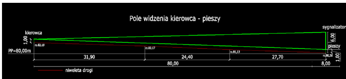
Rys. 4. Pole widoczności kierowcy ukazane w profilu podłużnym jezdni.
