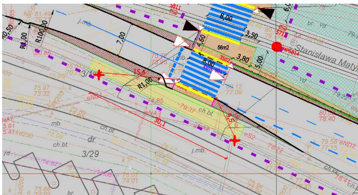
Rysunek 1. Rozmieszczenie istniejącego oświetlenia w rejonie przejścia.
