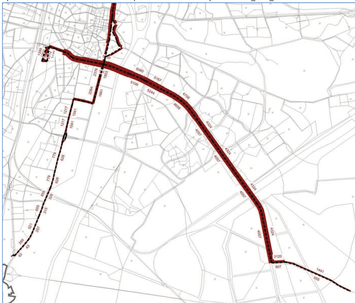
Rys. 2. Potoki dobowe w na linii BRT Sławie-Poznań Główny - wariant I_OPT_3 - 2040r.
