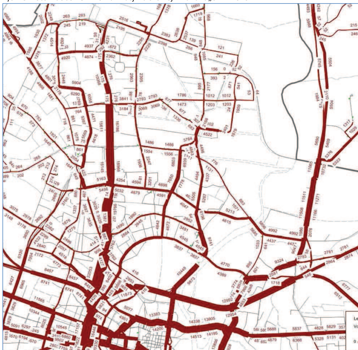
Rys. 18. Potoki dobowe w komunikacji zbiorowej - wariant „6AT” 2040r.
