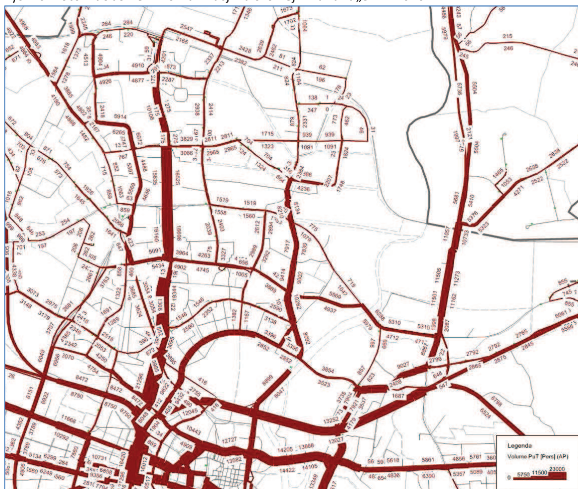
Rys. 16. Potoki dobowe w komunikacji zbiorowej - wariant „5AT” 2040r.
