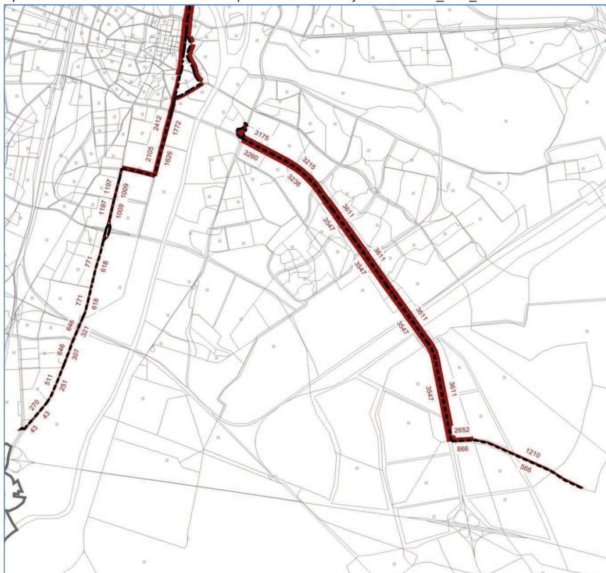
Rys. 4. Potoki dobowe w na linii BRT Sławie-Rondo Rataje - wariant II_OPT_3 - 2040r.
