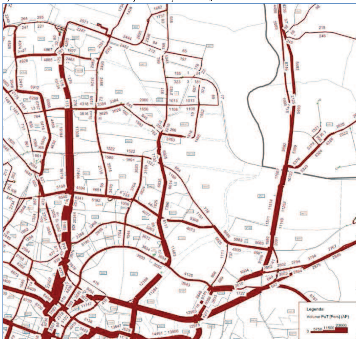
Rys. 14. Potoki dobowe w komunikacji zbiorowej - wariant „4A” 2040r.
