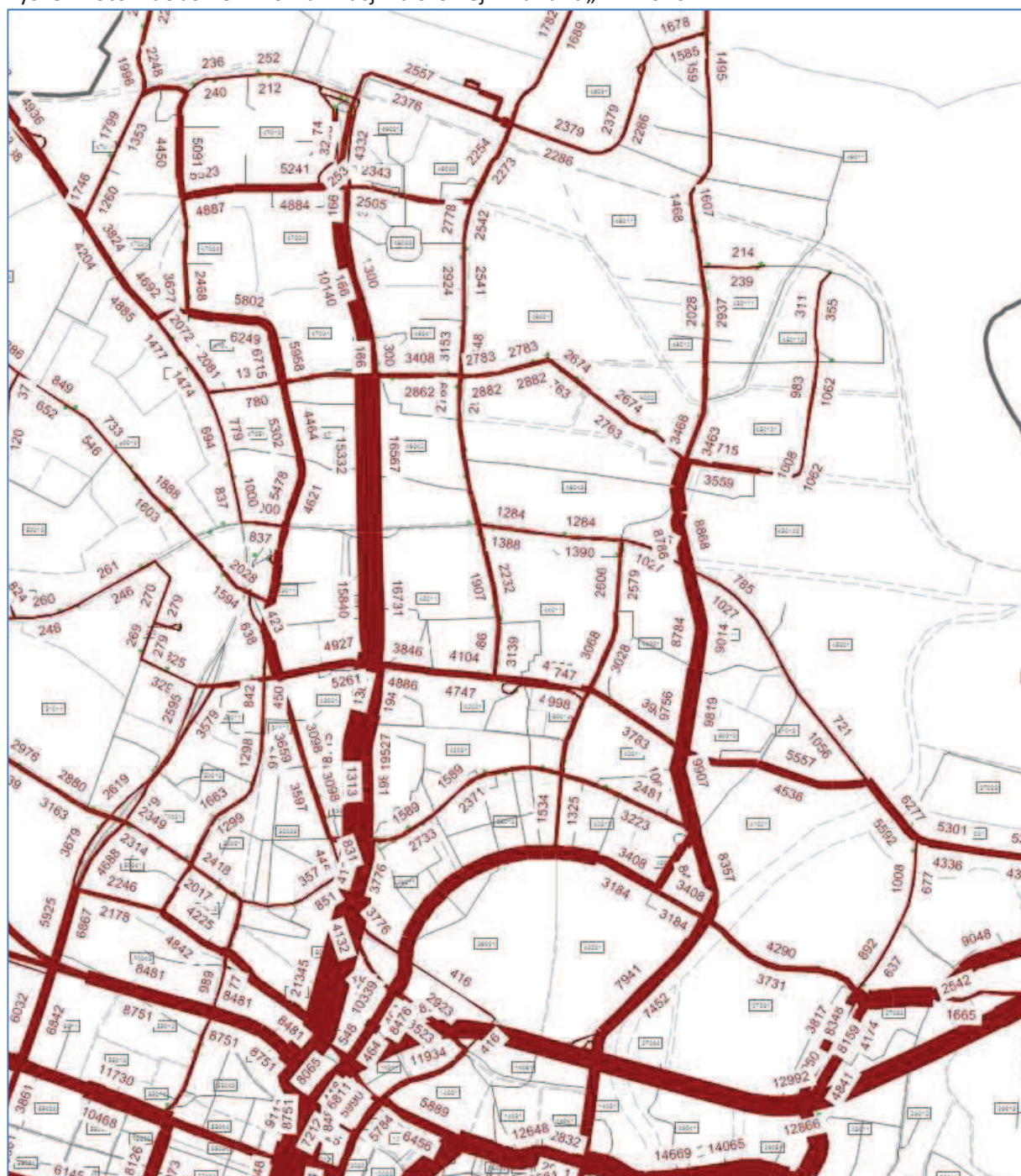
Rys. 8. Potoki dobowe w komunikacji zbiorowej - wariant „1T” 2040r.
