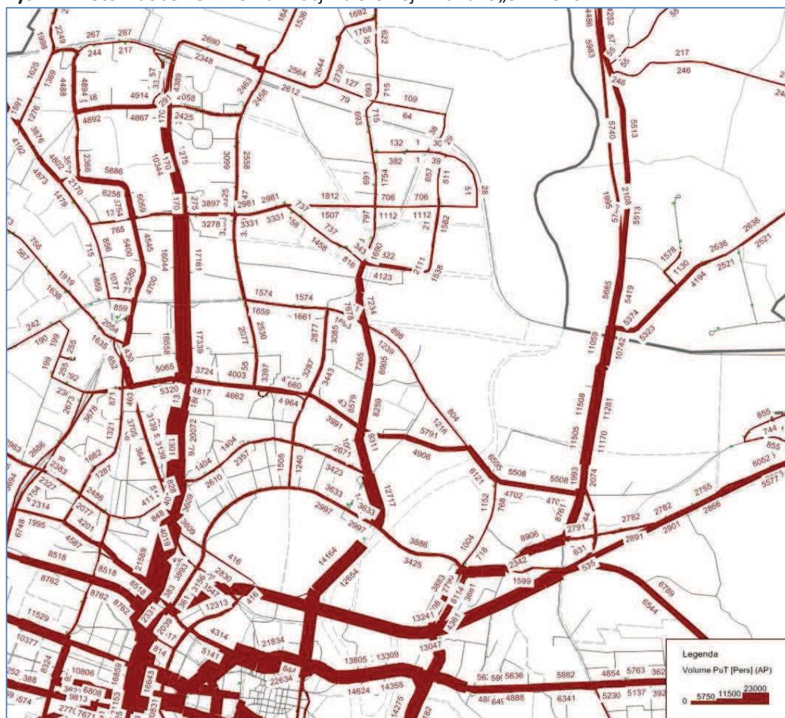
Rys. 12. Potoki dobowe w komunikacji zbiorowej - wariant „3T” 2040r.
